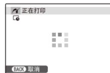
若打印中断, 请按下 **■** 关闭相机, 然后重新开启。
