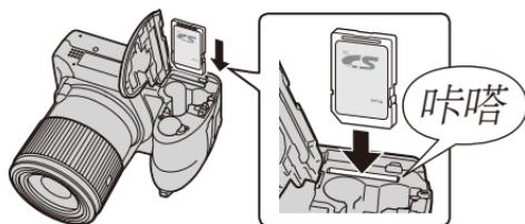
请确保存储卡插入方向正确,
