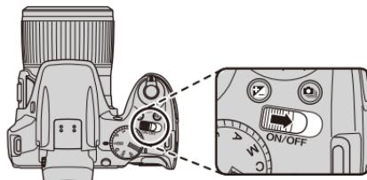
推动 **ON/OFF** 开关可关闭相机。
