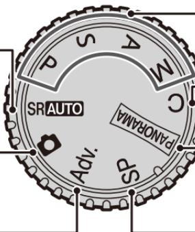
**P、S、A、M**: 用于完全控制相机设定, 包括光圈 (**M** 与 **A**) 和/或快门速度 (**M** 与 **S**) (■ 29)。
