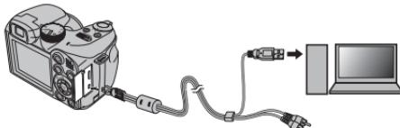
**3** Нажмите ▶ примерно на одну секунду, чтобы включить фотокамеру. Программа MyFinePix Studio или FinePixViewer запустится автоматически; следуйте инструкциям на экране, чтобы скопировать снимки на компьютер. Чтобы выйти из программы, не копируя снимки, нажмите **Cancel** (Отменить).
