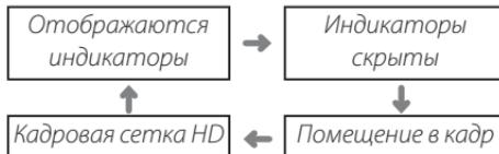
Чтобы скомпоновать снимок с помощью функции помещения в кадр, расположите основной объект на пересечении двух линий или совместите одну из горизонтальных линий с линией горизонта. При использовании кадровой сетки HD отображаются направляющие с соотношением сторон 16:9, облегчающие выкладовку HD-снимков. Воспользуйтесь блокировкой фокуса (стр. 33), чтобы сфокусироваться на объекте, который будет находиться не в центре кадра создаваемой фотографии.
