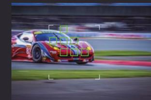
Perfekt für sich bewegende Motive, die mit einem einzelnen Fokusfeld schwer zu verfolgen sind. Halten Sie das Motiv einfach in der ausgewählten Fokuszonen. Innerhalb des Phasendetektpunktbereichs des Sensors arbeitet der AF dabei besonders schnell.
