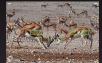
Die Kamera wählt passende Fokuspunkte automatisch aus und fokussiert dann auf das Motiv. Dieser Modus eignet sich für Motive mit unvorhersehbarer Bewegungsrichtung oder für Bilder mit mehreren sich bewegenden Motiven.
