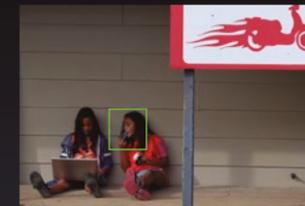
Für punktgenaues Fokussieren mit hoher Präzision. Wählen Sie eines von 91 oder 325 AF-Feldern aus. Dabei stehen jeweils fünf verschiedene Feldgrößen zur Auswahl.
