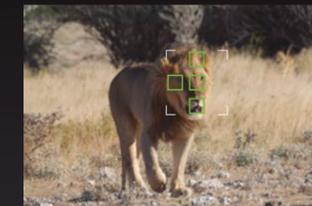
Nützlich für sich nicht besonders schnell bewegende Motive, die im Einzelpunktmodus schwierig zu fokussieren sind. Die Größe der Fokuszonen kann zwischen 3x3, 5x5 und 7x7 Fokuspunkten variieren. Die in der Sensormitte liegenden Phasendetektpunkte sorgen dabei für eine besonders hohe AF-Leistung.
